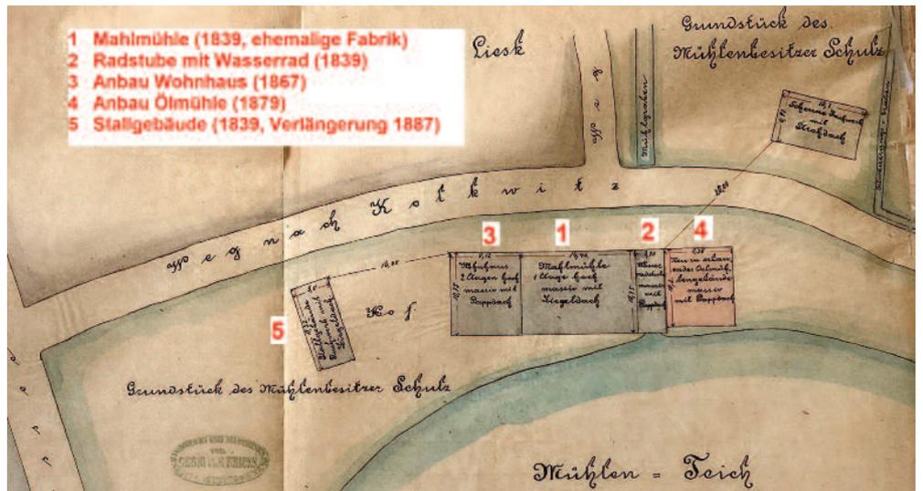
Abb. 1: Situationsplan aus dem Bauantrag für den Anbau einer Ölmühle von 1879 [4]
