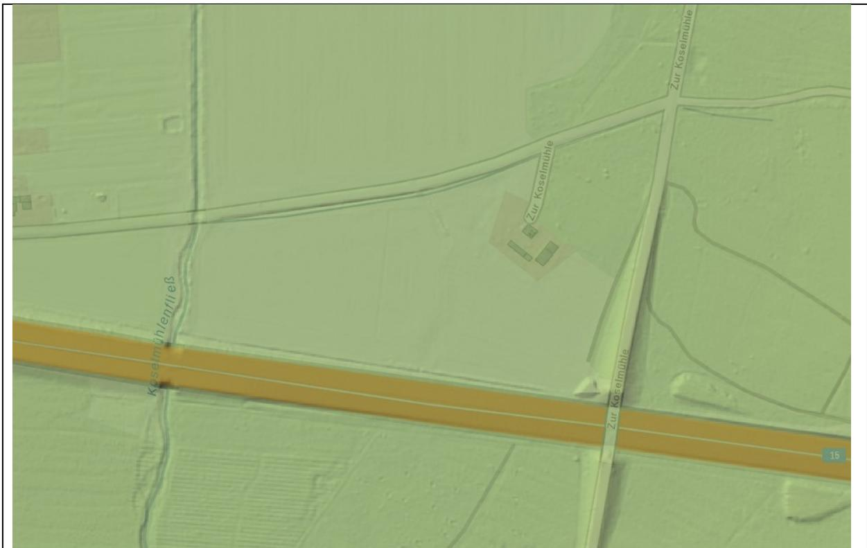
Das digitale Geländemodell zeigt die aktuelle Topographie mit den früheren, teilweise nur noch geringfügig erkennbaren Strukturen der Grabenläufe am Rand und innerhalb des Plangebietes und den Aufschüttungen im Zuge des Verkehrsflächenbaus der Bundesautobahn im vergangenen Jahrhundert.
