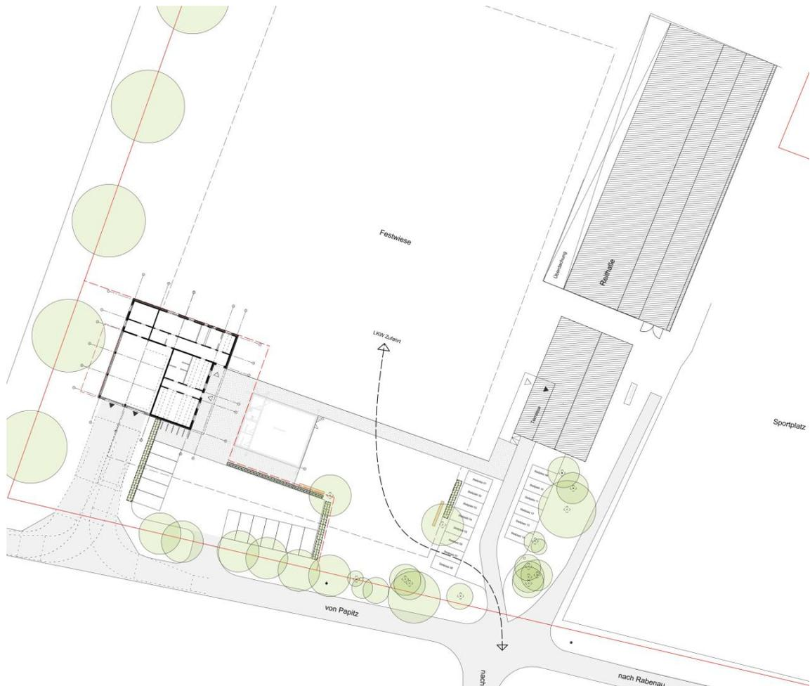
**Abb. 3:** Lageplan mit Vorentwurf des Neubaus des Feuerwehrgerätehaus Papitz-Dahlitz
